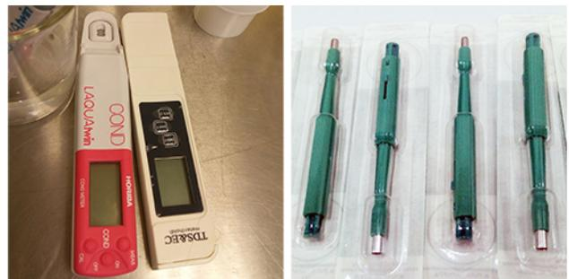
Preparando geles y emulsiones. Instrumentos: Medidores de pH, conductividad y contenido total de sólidos, Biopsia punches...
